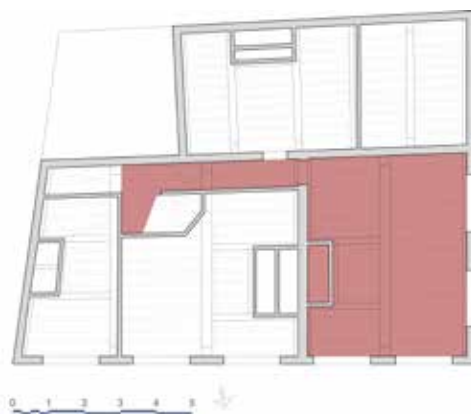
Reconstructie van de plattegrond der eerste verdieping van Haarlemmerstraat 311-313. In rood aangeduid de kamer van de rederijders aan de voorzijde van het pand, en de gang die vanaf de spiltrap naar de kamer leidde. Tekening: Erfgoed Leiden en Omstreken.
