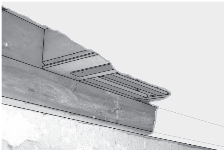
Hooglandsekerkgracht 21: reconstructie van de ophanging van het leemstucplafond met de latjes tussen en onder de kinderbinten.
